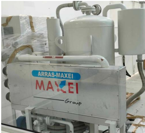
[Machine de retraitement et remplacement huile transformateur sur site client sous vide]
