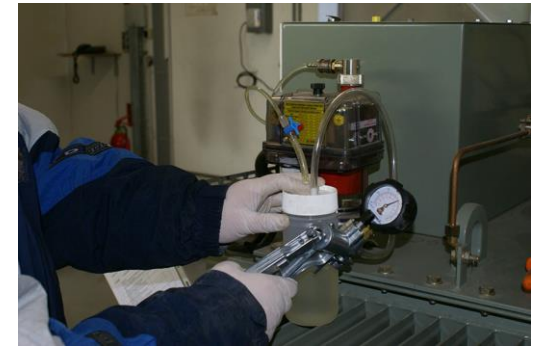
[prélèvement d'un échantillon d'huile pour analyse des gazes dissous]
